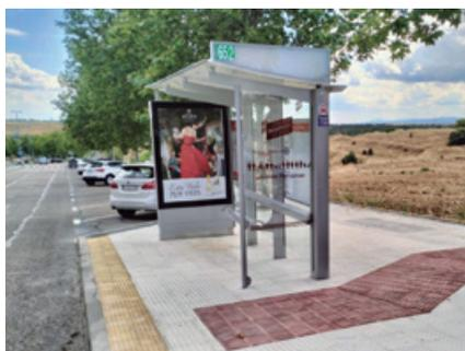
Están realizadas con materiales 100% reciclables, vidrios templados resistentes a los impactos con cantos biselados, y tienen iluminación LED de alta eficiencia energética, que da comodidad y seguridad a los usuarios. Además, disponen de un banco y un apoyo
